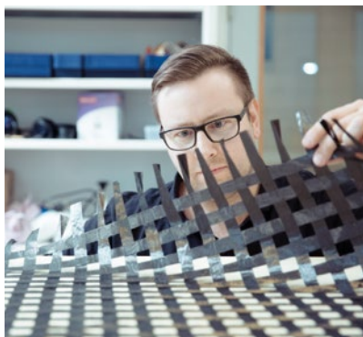
Armeringstyg av kolfiber från Oxeon.
