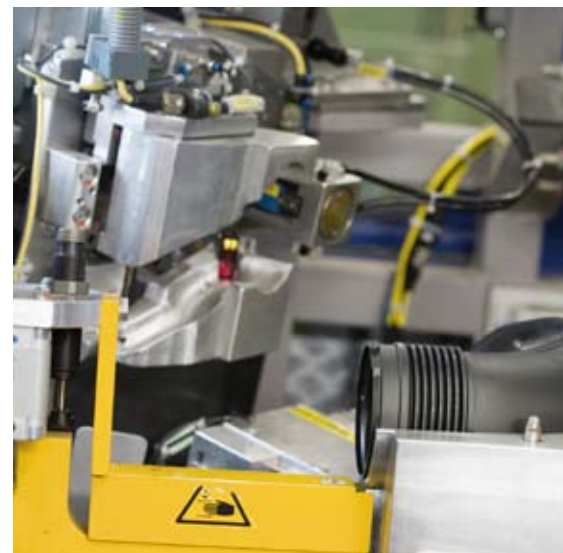
Hög grad av mekaniserad produktion. Här sker efterbearbetning av ett formblåst insugsluftör.
