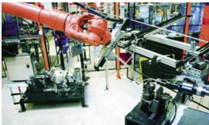
Robotiserad bockning och läcksökning av bränslerör.
