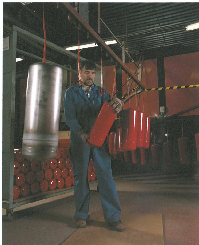
Produktion av brandsläckare i Eskilstunafabriken.
