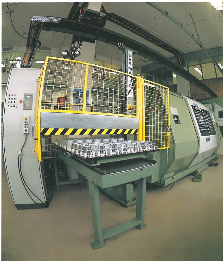
Japansk fleroperationssvarv, OKUMA, med svenskbyggd laddningsutrustning, levererad av Stenbergs till Victor Hasselblad AB, Göteborg.
