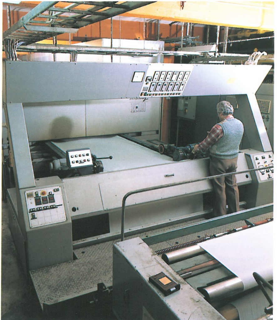
På Marieholms Yllefabrik finns denna spannram som torkar, krymper och fixerar i en och samma process.
