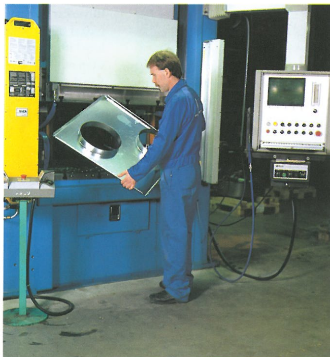
Hydraulpress med 300 t tryckkraft i PM-Lufts plåtverkstad
