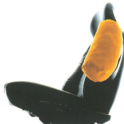
Teknisk textil från FOV Fabrics i nyutvecklad sidokrockkudde
