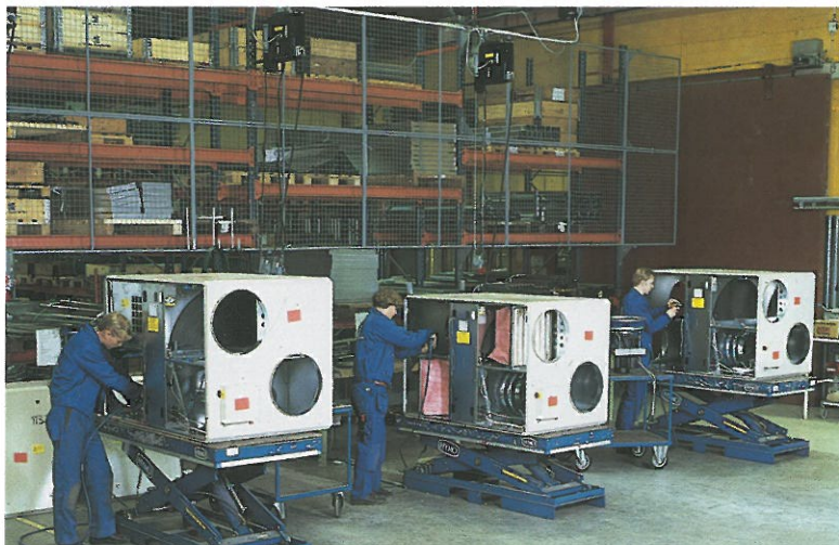
Montering av GOLD-aggregat
