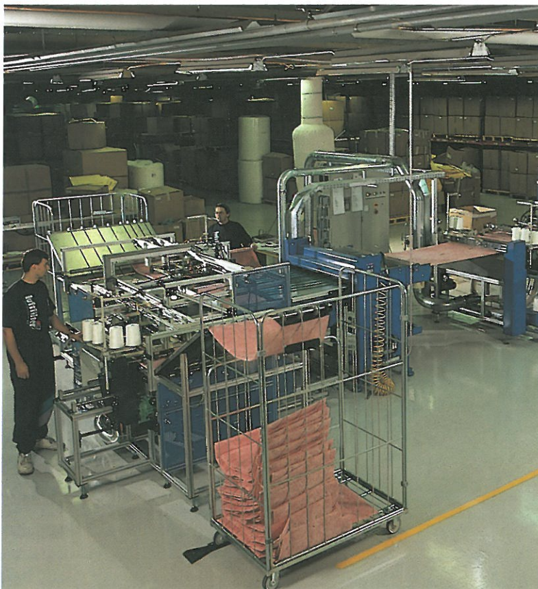
Helautomatisk sömnadsanläggning för filterpåsar hos IF Luftfilter i Borås
