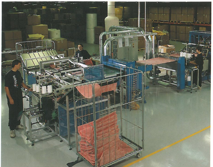
Helautomatisk sömnadsanläggning för filterpåsar hos IF Luftfilter i Borås
