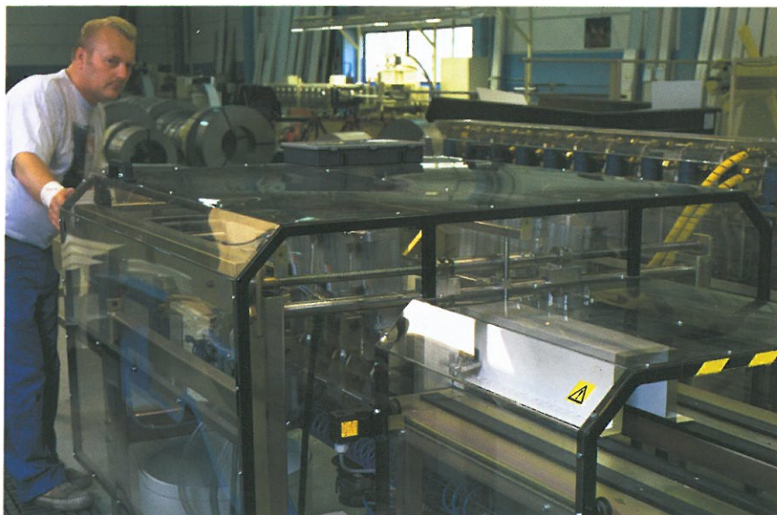
Automatisk framställning av kylbafflar hos Stifab Farex i Arvika
