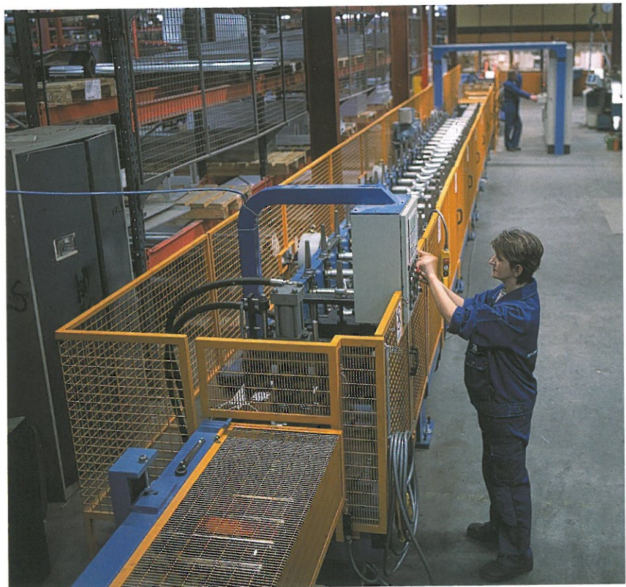
Helautomatiskt profilverk hos PM-LUFT i Kvänum.
