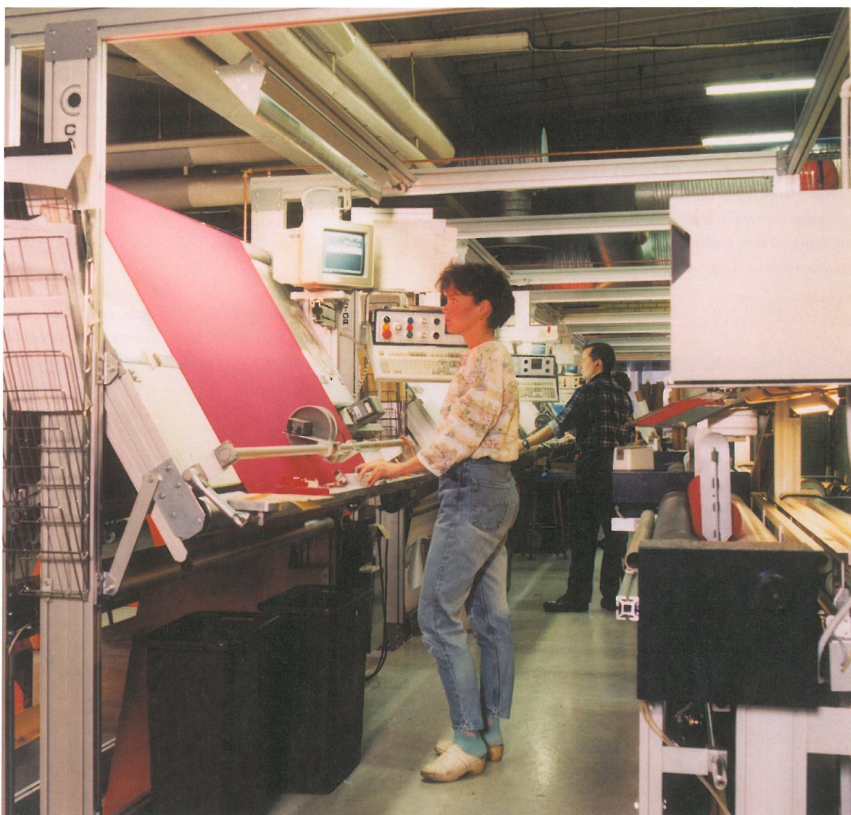
Slutkontroll av väv för airbags hos FOV Fabrics i Borås.
