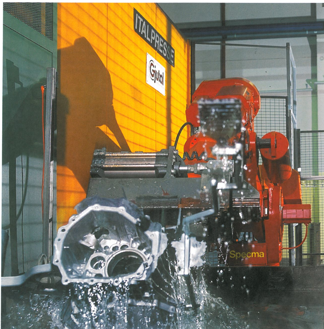
Robotinstallation levererad av Specma.
