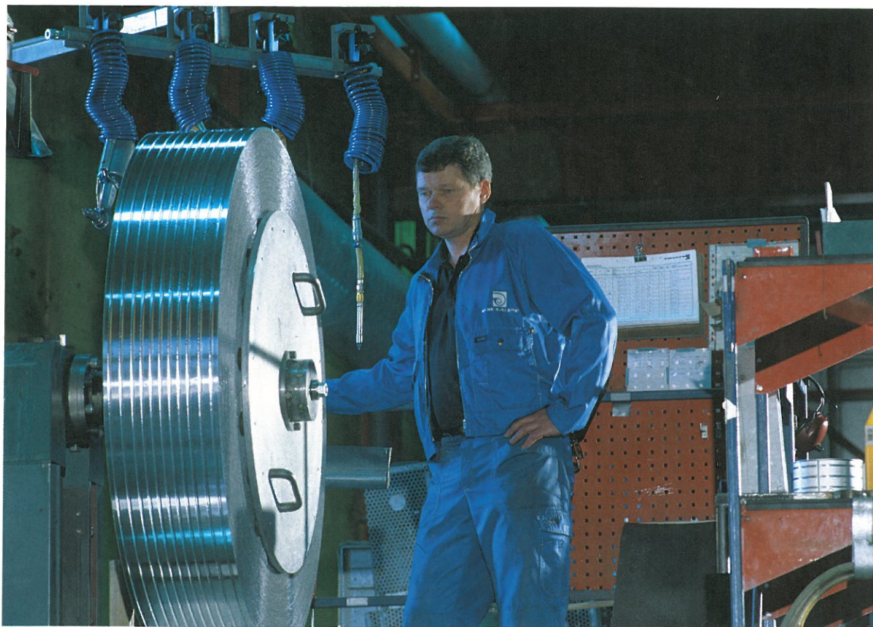
Automatiserad tillverkning av roterande värmeväxlare hos PM-LUFT.
