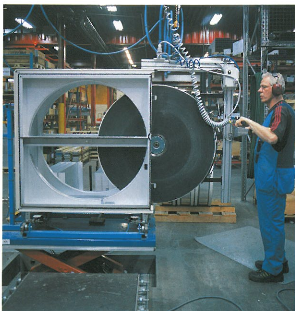
Montering av roterande värmeväxlare hos PM-LUFT i Kvänum.
