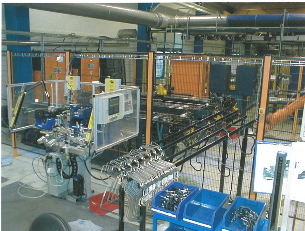
Högautomatiserad produktionsutrustning för tillverkning av ledningssystem för bilindustrin hos Dayco Automotive.
