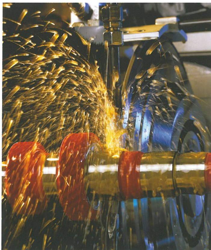
Rundslipning av växellådsaxel med "Quickpoint"-teknik i maskin levererad av Specma.
