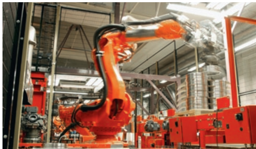
Robotar laddar och plundrar lagerringar i SKF's nya hårdlinje i Göteborg. Ringar av olika storlek hanteras med höga krav på precision och genomloppstider. Utrustningen är levererad av Specma Automation.
