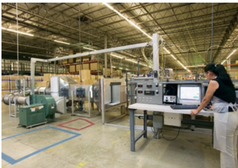
Test av mikrofilter. Alla mikrofilter testas och förses med testprotokoll som visar att filtret uppfyller kraven för aktuell filterklass.
