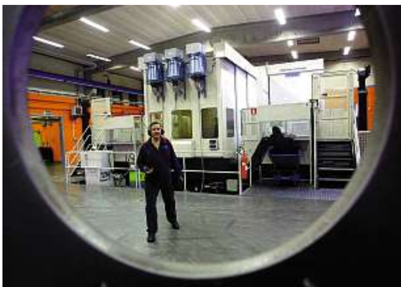
Toshiba BTF arborrverk, levererat av AB Sigfrid Stenberg till Wahlquists Verkstäder i Ödesbög, för bearbetning av maskinstativ till Tetra Pak.
