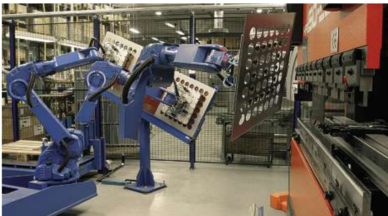
Robotmodul för kantvikning och bockning vid STIFAB FAREX fabrik i Tomelilla.
