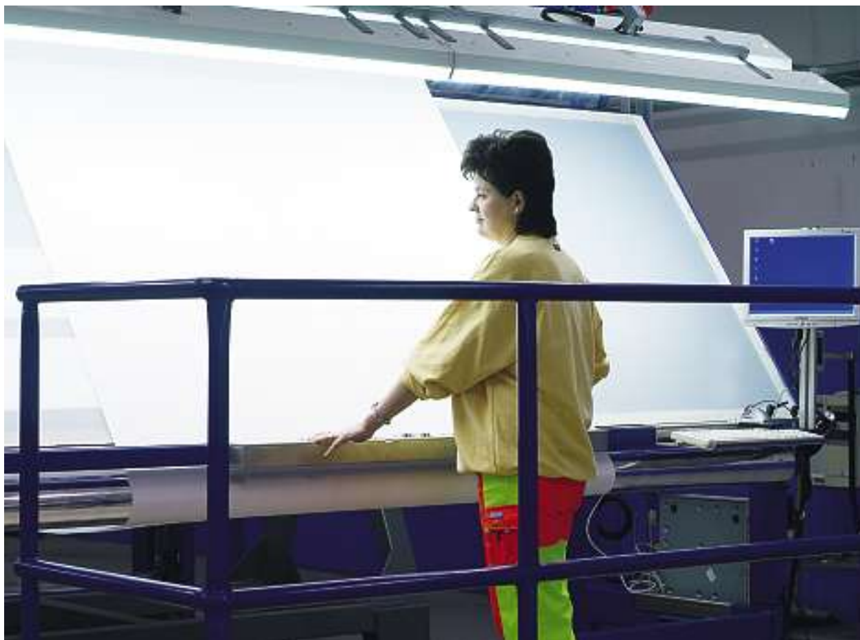
FOV Fabrics avsyningsutrustning för väv med en bredd upp till 2,5 m.
