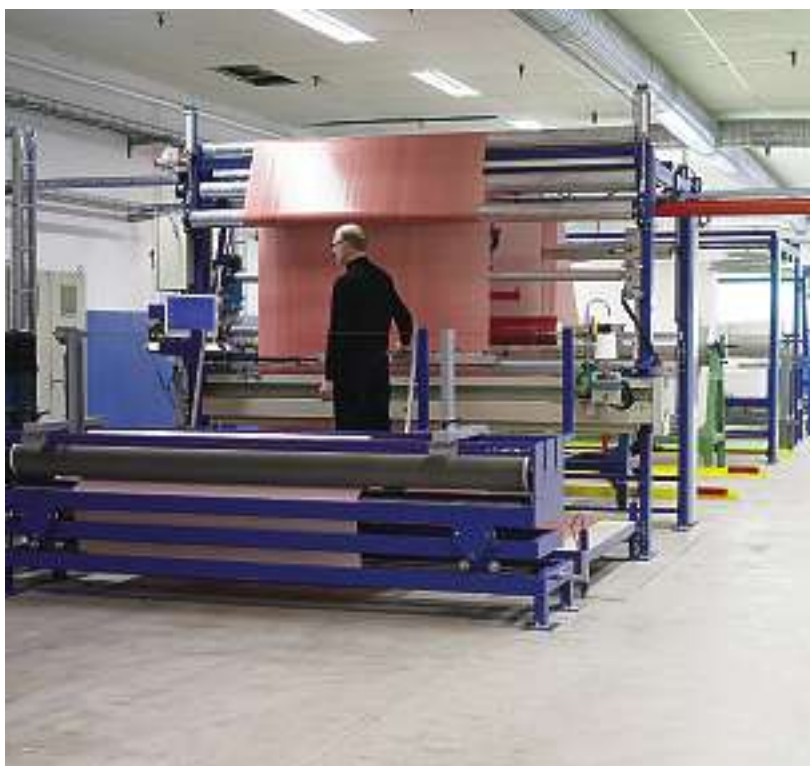
FOV Fabrics utrustning för att kunna leverera airbagväv på 1 500 metersrullar.
