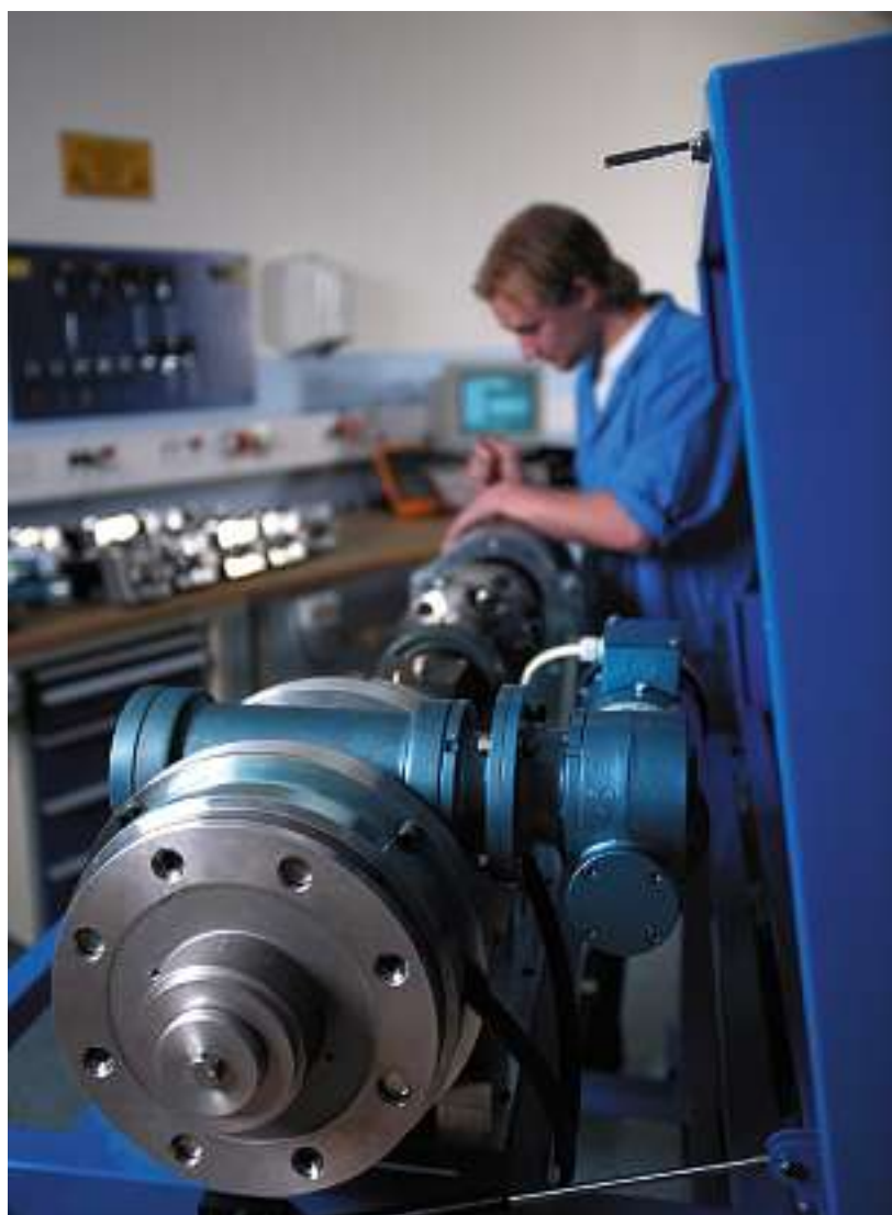
SOMAS Instrument AB använder Specma Seals tätningar som viktig komponent i vridspjällventiler för processindustrin.
