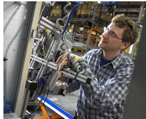
Montering av de välkända GOLD-aggregaten görs industriellt, varje storlek monteras på sin line med väl utvecklade hjälpmedel på varje station.
