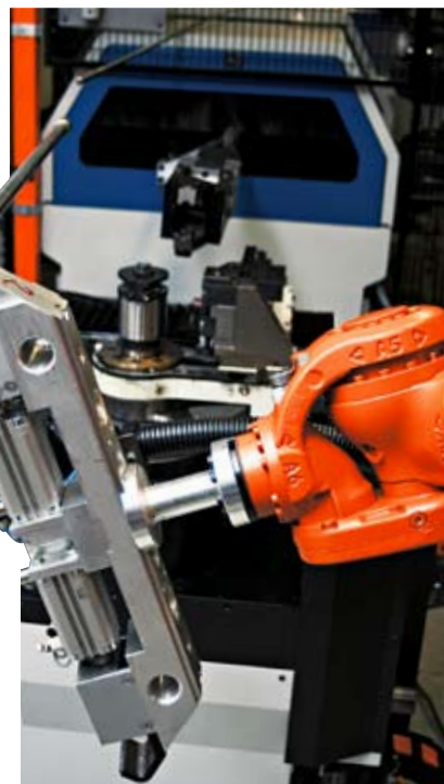
Automatisk produktionscell för bockning, ändformning, lödning och tvättning av AC-ledningar.
